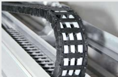
Stromzufuhr zur Kabine mittels Energiekette
